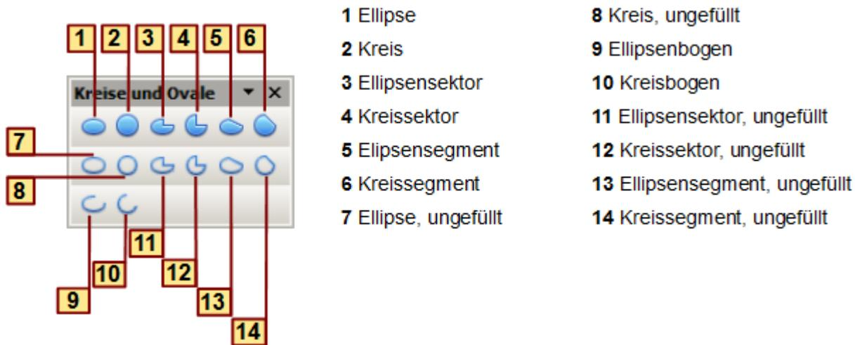
Abbildung 8: Ellipsen- und Kurvenwerkzeuge im Werkzeugmenü (Symbolleiste) Kreise und Ovale
